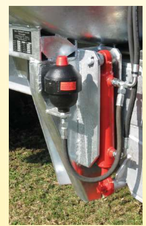
Hydr. Deichselfederung mit Gasdruckdämpfer bzw. hydr. Talausbringung
